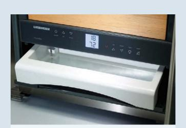
Il serbatoio integrato può contenere un litro di acqua distillata. I sensori regolano l'evaporazione dell'acqua e garantiscono in modo preciso il mantenimento dell'umidità selezionata. Il display segnala quando è necessario aggiungere acqua.
