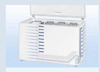
I congelatori orizzontali Liebherr hanno il condensatore inserito nelle pareti esterne: durante il funzionamento non si forma mai condensa. Anche **l'evaporatore è schiumato** in prossimità delle pareti interne: la temperatura uniforme all'interno del vano vi permetterà di congelare gli alimenti senza doverli riposizionare.
