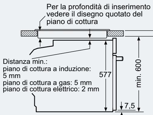
Se l'apparecchio viene montato sotto un piano di cottura deve essere rispettato il seguente spessore piano di lavoro (event. incl. sottostruttura).
