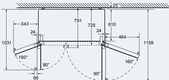
Vasca di raffreddamento completamente estraibile con angolo di apertura della porta di 160°
