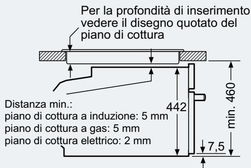
Se l'apparecchio viene montato sotto un piano di cottura deve essere rispettato il seguente spessore piano di lavoro (event. incl. sottostruttura).
