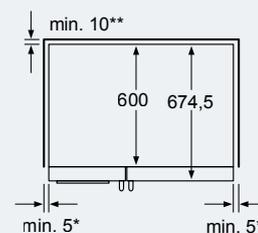
\* Se l'apparecchio viene montato vicino a una cucina, la distanza laterale deve essere di min. 76 mm.
